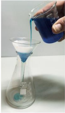
7. Kupfersulfatlösung in den Trichter geben. Kupfersulfatlösung filtrieren.
