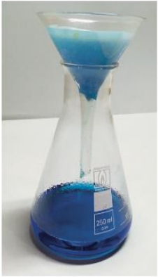
7. Kupfersulfatlösung in den Trichter geben. Kupfersulfatlösung filtrieren.
