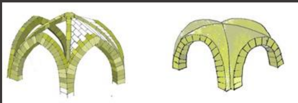
Rippengewölbe und Grätgewölbe, statisches Modell
